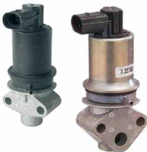
Rys.47 Przykłady elektrycznych zaworów recykulacji spalin, dla silników samochodów Audi, Seat, Skoda i VW, które po zamontowaniu wymagają procedury adaptacji. (Źródło: Pierburg)
