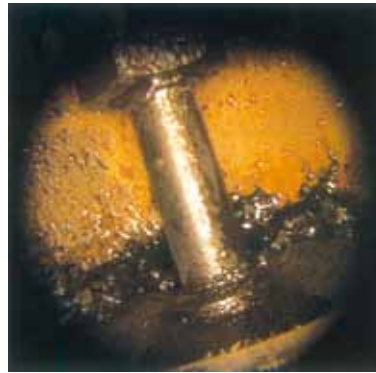
Rys.46 Trzonek zaworu recykulacji spalin i jego obudowa, pokryte kondensatem ze spalin (skroplona para wodna znajdująca się w spalinach, o kwaśnym odczynie, wskutek rozpuszczenia w niej kwaśnych produktów spalania). (Źródło: Pierburg)
