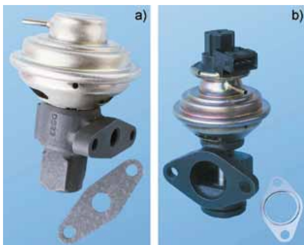
Rys.32 Przykłady pneumatycznych, wzniosowych zaworów recykulacji spalin: rys.a) dla silnika ZI, o małym masowym natężeniu przepływu spalin; b) dla silnika ZS, o dużym masowym natężeniu przepływu spalin, z czujnikiem położenia grzybka zaworu. (Źródło: Pierburg)
