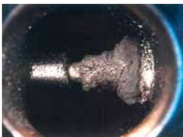
Rys.45 Grzybek zaworu recykulacji spalin, pokryty osadami typu węglowego, tzw. nagarami. (Źródło: Pierburg)
