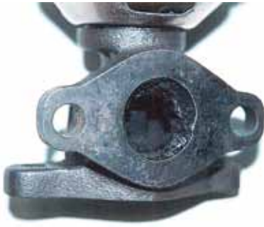
Rys.43 Zawór recykulacji spalin pokryty osadami typu węglowego, tzw. nagarami. (Źródło: Pierburg)
